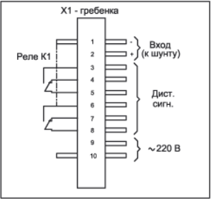
Рис.108. Схема подключения УИТ-4
