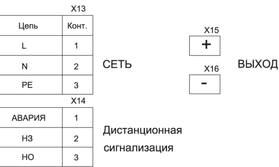
Рис. 51. Схема подключения выпрямителей ВБВ 24/10-2К, ВБВ 48/6-2К, ВБВ 60/5-2К (для самостоятельной поставки)
