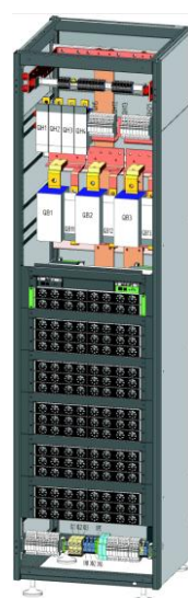
Рисунок 2.5 - Пример размещения устройств внутри панели ввода и распределения УЭПС-5 48/2000-6060+8.8 и УЭПС-5 60/1800-6060+8.8
